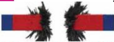
شكل (٥): الأقطاب المغناطيسية المتماثلة تتنافر
